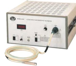
Model 341B Electrostatic Voltmeter
